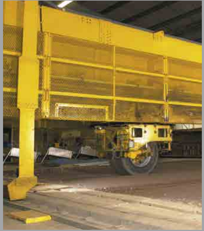
2000 - Các thử nghiệm thử tải trong phòng thí nghiệm tại phòng thí nghiệm Nghiên cứu Giao thông Vương quốc Anh so sánh lưới địa kỹ thuật Tensar với các dạng lưới địa kỹ thuật khác
